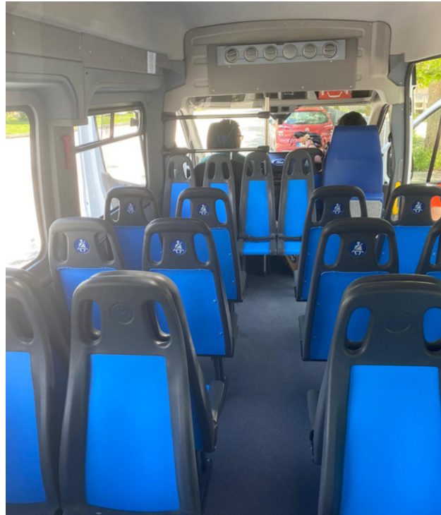
Realizzazione dei sedili dei passeggeri conformi alla normativa DM 01.04.2010 autoestinguenti, antivandalo con cinture di sicurezza addominali, e maniglione.
