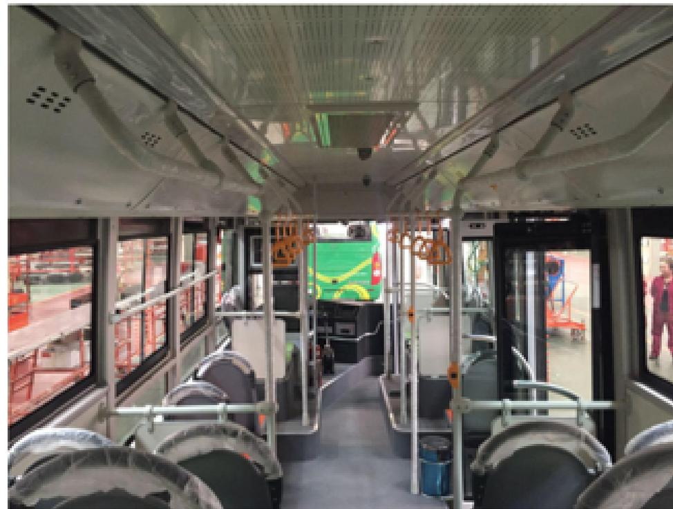
Le aree interne includono soffitto in lega di alluminio, pavimento in sabbia di quarzo colorato, sedili, lampada LED, corrimani di ferro, vetri a protezione UV e finestrini.
