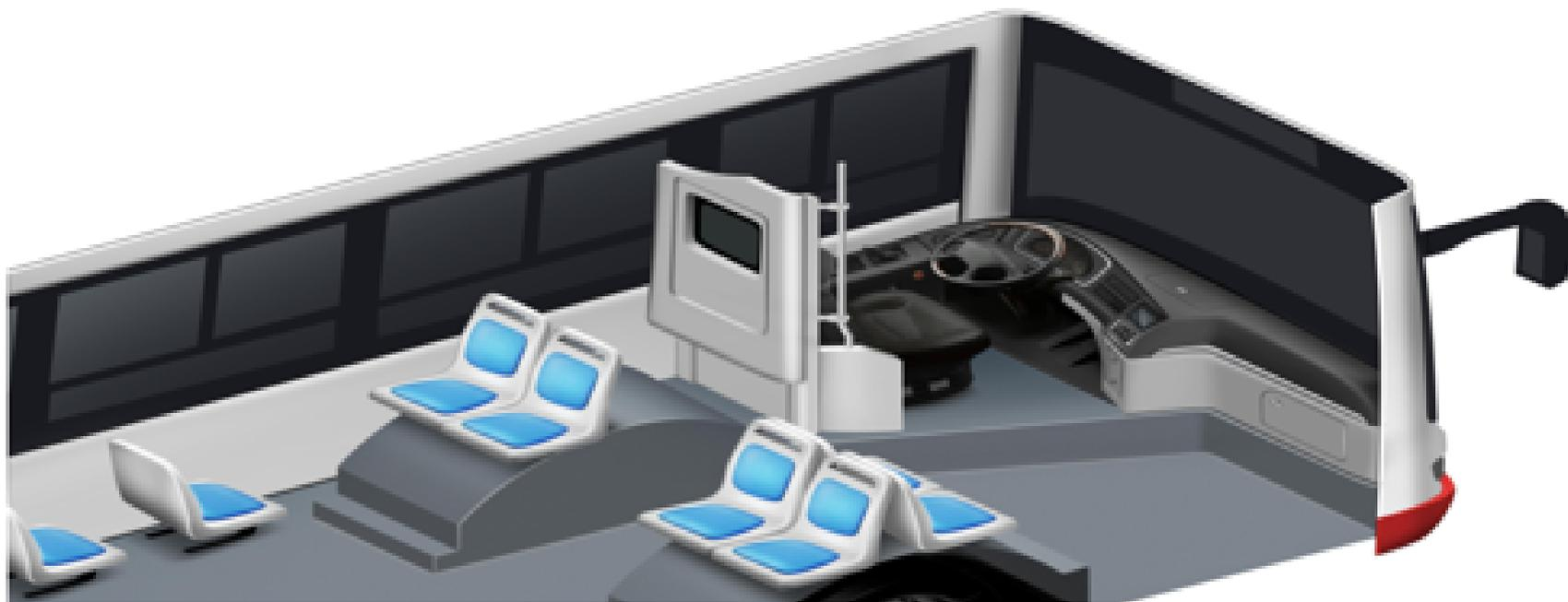
Il grande abitacolo è semi chiuso per dare uno spazio confortevole al guidatore. Il cruscotto ha un computer di bordo che integra tutti i sistemi di controllo e le informazioni sullo stato del veicolo (inclusa velocità, consumo di potenza, temperatura, ECAAS car control).
